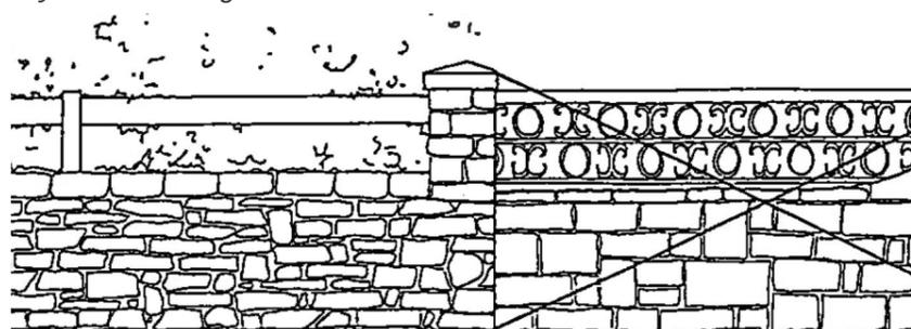
La lisse qui peut surmonter le mur (en agglomération) doit être la plus simple possible, avec potelets et traverse de préférence unique, plate, en bois.
