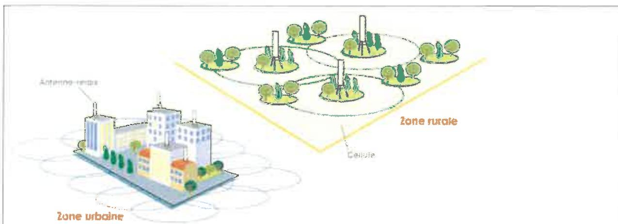
L'antenne-relais émet des ondes dans une direction privilégiée. Ce faisceau peut être comparé à celui d'un phare qui éclaire la mer. Les faisceaux principaux de l'antenne sont directifs et très fins (6 degrés environ) dans le plan vertical. L'intensité du faisceau diminue très rapidement (en fonction du carré de la distance) en s'éloignant de l'émetteur. Cf. schéma ci-dessous à titre indicatif.
