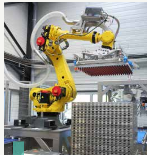
Atelier de fabrication d'un llot robotisé de préparation à la stérilisation.
